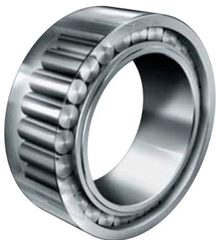
Os rolamentos de Rolos Cilíndricos sem gaiola, identificados pelo prefixo SL, são fabricados de uma a quatro carreiras de rolos, sendo sua principal característica a altíssima capacidade de carga radial por conterem o maior número possível de elementos rolantes. Porém, o limite de rotação é menor se comparado aos rolamentos com gaiola.
