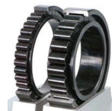
Indicado pelo Sufixo **BR**, estes rolamentos apresentam escurecimento nos elementos rolantes e anéis devido ao processo de oxidação negra. Este tratamento superficial tem a função de reduzir o risco de falha por escorregamento causada por situações de baixa carga e mudanças repentinas de velocidade.
