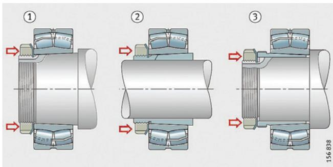
A fixação do rolamento é obtida deslocando-o sobre o cone. Nesta condição, o seu anel interno se expande, diminuindo conseqüentemente a sua folga radial. A redução da folga radial interna é a diferença entre a folga antes e após a montagem. Desta forma deve-se medir a folga do rolamento diversas vezes durante a sua montagem, até ser atingida a folga residual pré-estabelecida ( $S_r$ ).
