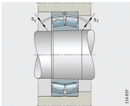
Pode-se também ajustar a folga radial pelo deslocamento axial do anel interno sobre o cone. Neste caso deve-se medir a folga interna com o rolamento desmontado, se o valor estiver próximo ao mínimo utilizar na montagem o menor valor do deslocamento axial na faixa de tolerância e se o valor da folga radial estiver próximo ao máximo empregar o maior valor do deslocamento axial. Na tabela encontram-se os valores de montagem para rolamentos com furo de 30 a 1250mm.
