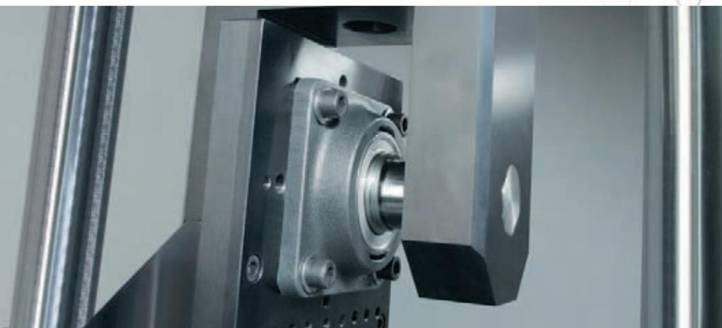
Mancal industrial conforme qualidade automobilística: Nos laboratórios de ensaios próprios, todos mancais de catálogo são submetidos a testes de fadiga. Na INA produz-se de acordo com as normas internacionais mais severas
